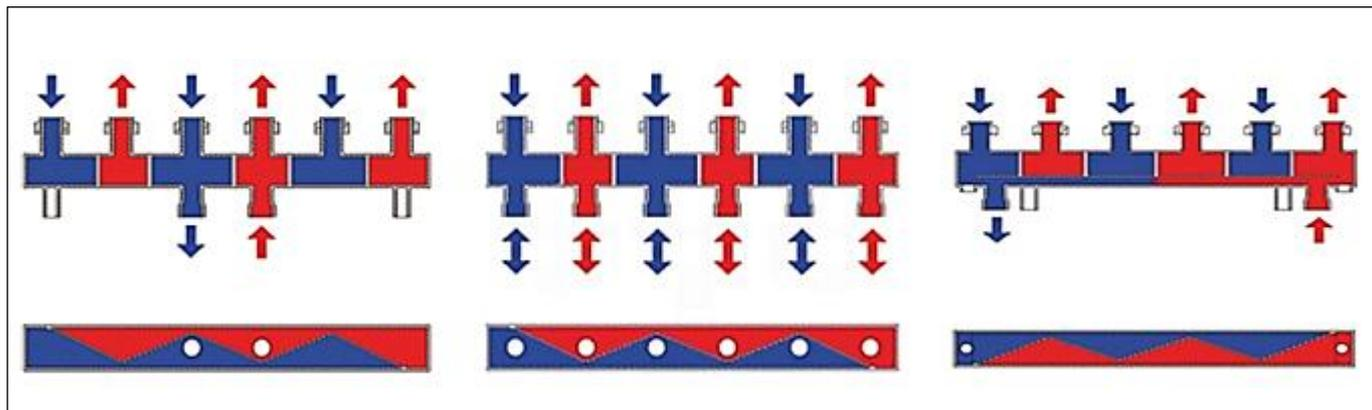
Верхние патрубки коллектора оснащены накладными гайками для обеспечения быстрого монтажа насосных узлов и элементов гидромодуля, а нижние имеют наружную резьбу.
