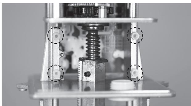
3. На стойки при помощи четырех винтов смонтировать плату с кулачками. Зубья вала платы должны попасть на зубья штока. Если шестерня попала в шток привода корректно, вал не будет свободно проворачиваться.
