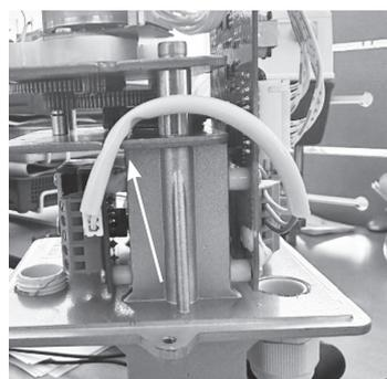
5) При помощи шлицевой отвертки настроить кулачки на плате. Дальний кулачок соответствует нижнему положению привода. Ближний кулачок соответствует верхнему положению привода. Сначала настраивается дальний кулачок, потом ближний.
