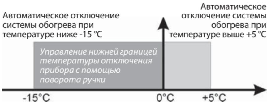
Рис. 2. График работы терморегулятора в зависимости от температуры
