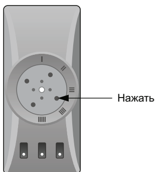
Рис. 3. Расположение штока на термовыключателе термостата.
