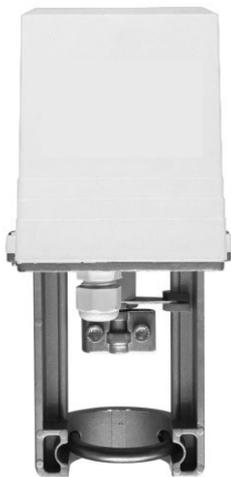
Электропривод ARV(E)-1000R предназначен для управления регулирующими клапанами VFM-2R (через адаптер)\*, VF-3R и VF-2R DN 15–50. Управление приводом Ридан ARV-1000R осуществляется по импульсному сигналу от электронных регуляторов Ридан типа ECL-3R/4R или подобных. Привод ARE-1000R управляется по аналоговому сигналу от контроллера, который поддерживает такой тип управления.
