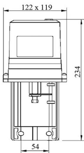
Привод имеет один кабельный ввод PG11 для кабеля 5-10мм.
