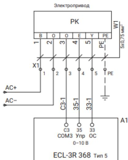
**Внимание!** Если в приводе имеются настраиваемые концевые выключатели, необходимо обязательно произвести их настройку. Проверить работу концевых выключателей - двигатель должен отключаться при помощи концевых выключателей, при достижении настроенного крайнего положения.
