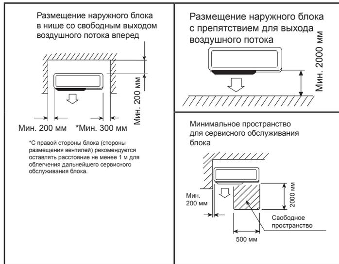
Размещение наружного блока с препятствиями спереди и сзади
