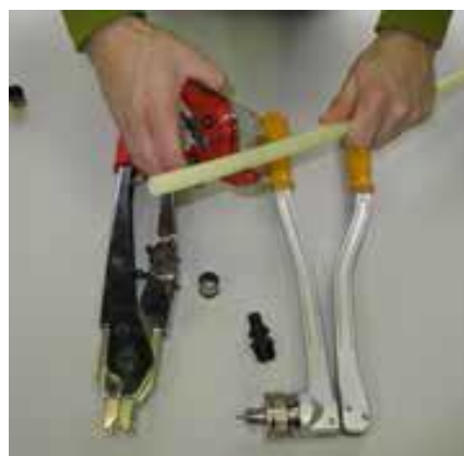
2. Отрежьте трубу и выберите нужный фитинг.
