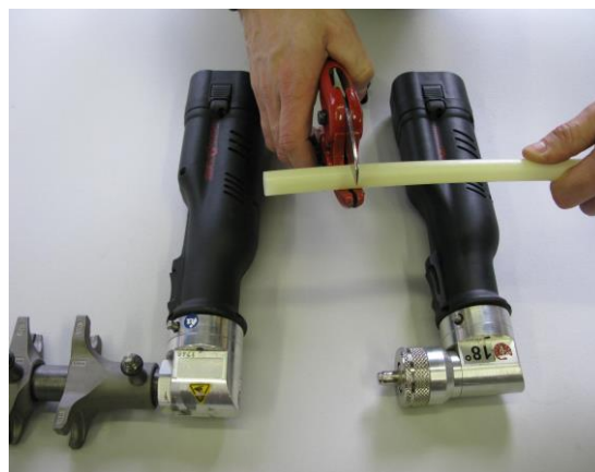
2. Отрежьте трубу и выберите нужный фитинг.
