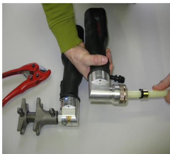
4. Вставьте расширитель в трубу.
