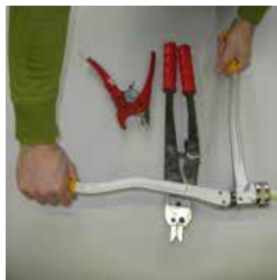
4. Вставьте расширитель в трубу.
